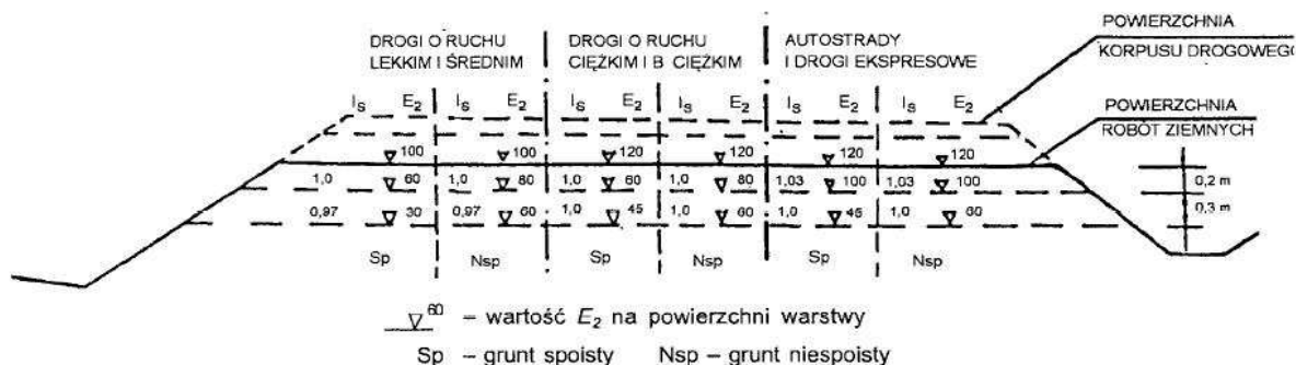
Rysunek 4 – Wartości wymagane w podłożu wykopów: wskaźnika zagęszczenia I_s i wtórnego modułu odfkształcenia E_2 , megapaskali
