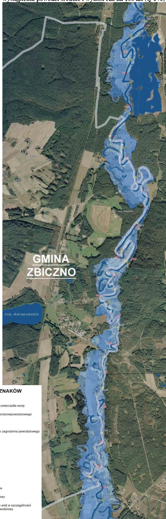
Rys. 26. Fragment mapy zagrożenia powodziowego wraz z głębokością wody – Rzeka Drwęca. Prawdopodobieństwo wystąpienia powodzi średnie i wynosi raz na 100 lat (Q 1%)
